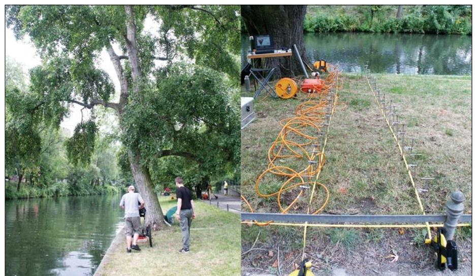
Abb. 1: Sondierung des Untergrundes einer Versuchsfläche am Landwehrkanal mit dem Georadar-Messsystem SIR 3000 (links); lineare Elektrodenauslage im Bereich des Silberhorns am Berliner Landwehrkanal (rechts)
