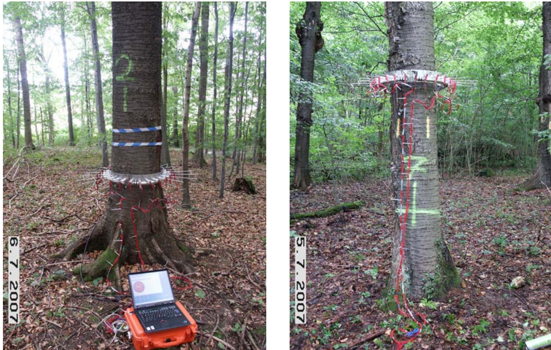
Abb. 1: Diagnose von Kernfäule mittels elektrischer Widerstandstomographie in der unteren und mittleren Messebene an zwei Vogelkirschen
